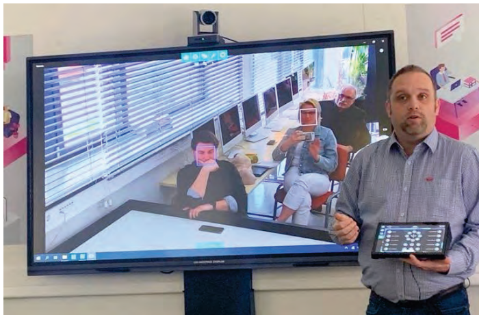
49. ábra A hibrid rendszerek interaktív kijelzője és a felette elhelyezett tanulók képét közvetítő PTZ kamera arcfelismerés során 120
