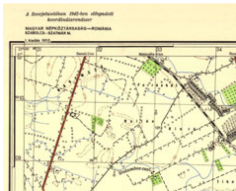
26. ábra. A Gauss-Krüger térképek szelvényhatárai a szélességi és hosszúsági köröket követik.
