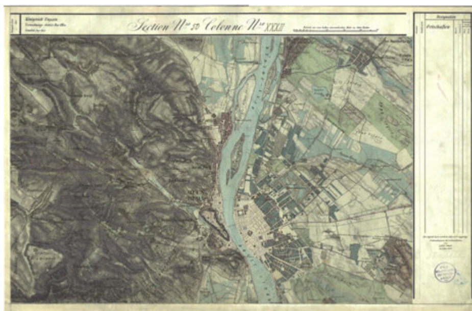
29. ábra. A második katonai felmérés szelvényein sem találunk koordináta-megírást: a georeferenciát itt is a szelvénytérkép (Section 50 Colonne XXXII) hordozza.
