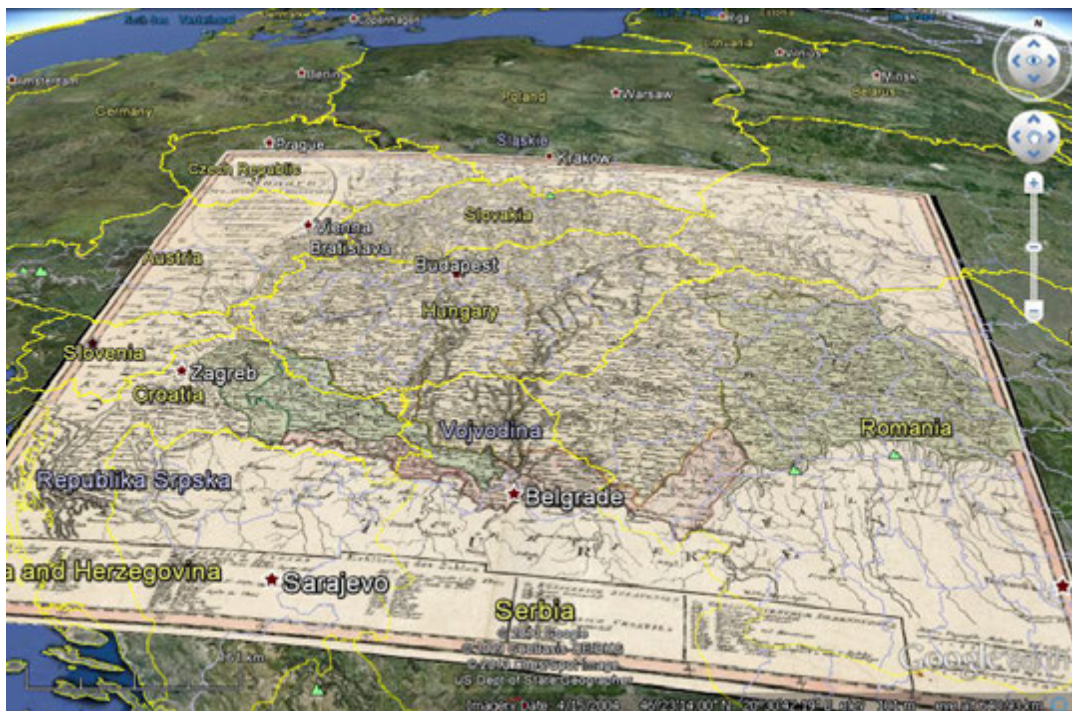
1. ábra. Goetz és Probst 1844-es Magyarország-térképe a Google Earth felületén: teljesen különböző technológiákkal készült adatok egységesítése a georeferencia által.
