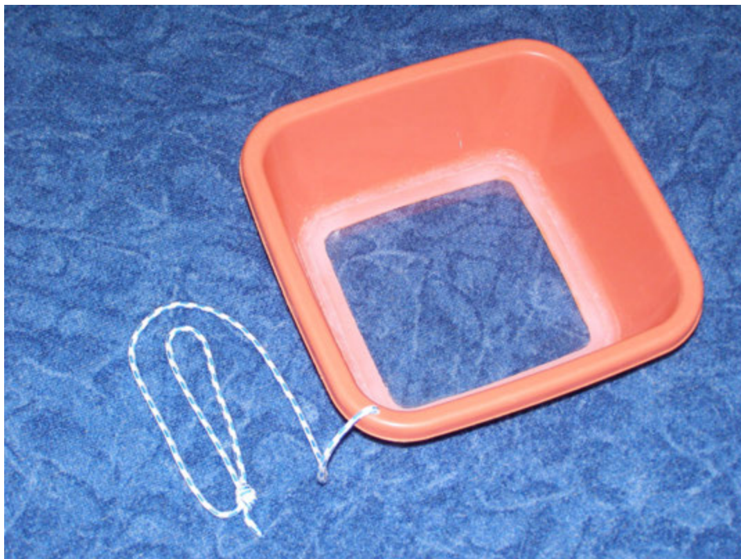
4.4. ábra Akvaszkóp a megfigyelésekhez
