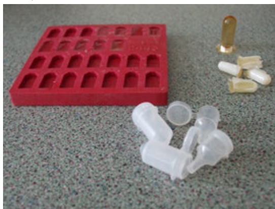
4.22. ábra. Kiöntőformák: balra piros szilikon-gumi kiöntőforma, az előtérben áttetsző, kupakos polietilén kapszulák, a háttérben jobbra sárga színű araditblokkok felnyitott kapszulában és már kapszula nélkül
