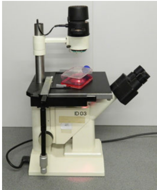
5.53. ábra. Fordított állású mikroszkóp oldalnézete. A tárgyasztalon tenyészfalaska látható, amelynek mozgatása a tárgyasztalon általában szabad kézzel történik
