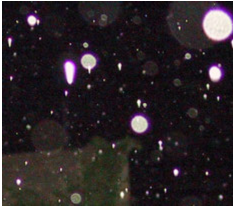
2.71. ábra. Kromatikus hiba következtében a fényfoltok szegélye „szellemképes”
