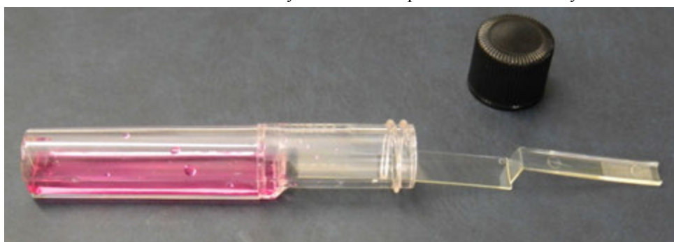
5.49. ábra. Polisztirol tenyésztőlemez és kupakkal lezárható edénye
