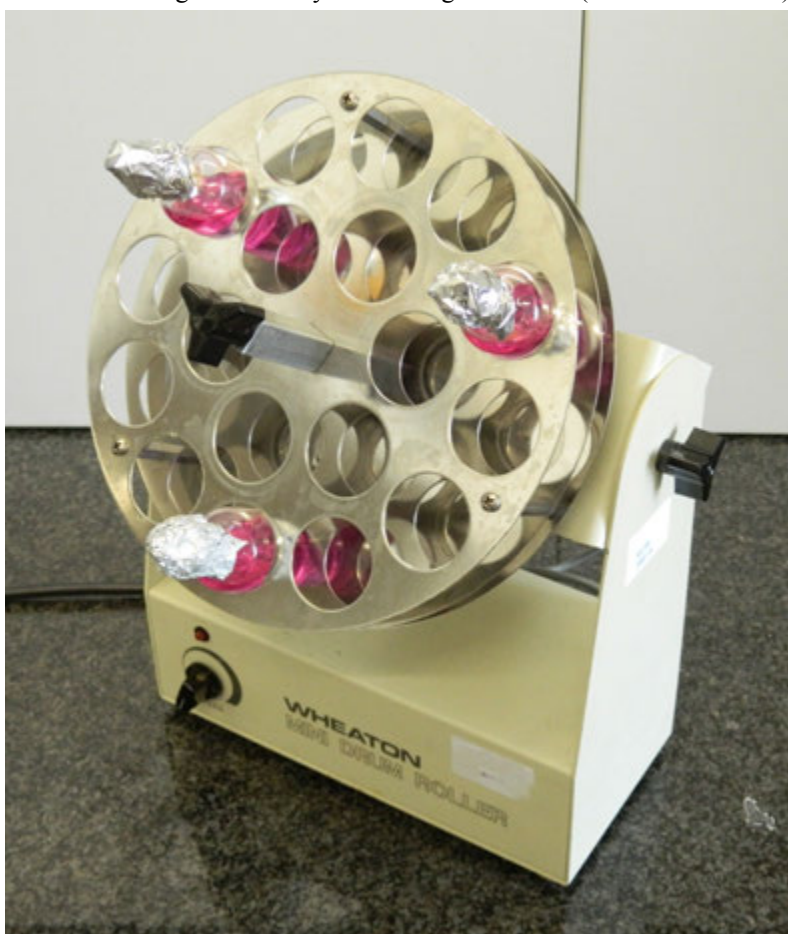
5.55. ábra. Forgócsöves tenyészetek forgató dobban (elől- és oldalnézet)
