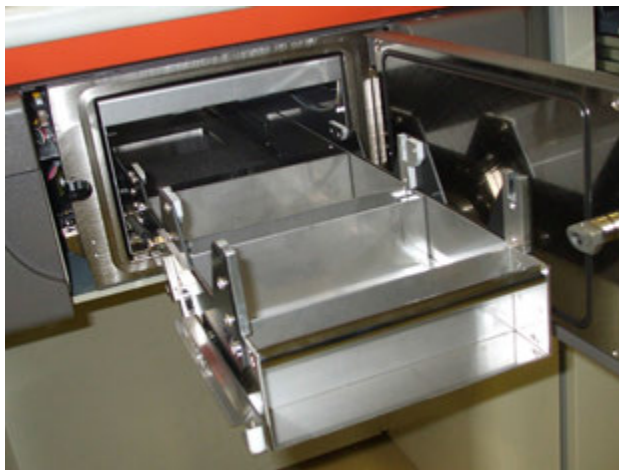
4.13. ábra. A síkfilmes negatívok számára kialakított kazetták helye a mikroszkóp lábazatában
