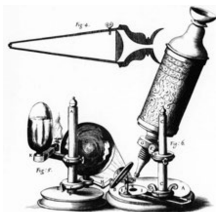
2.57. ábra. Hook mikroszkópja: alul a mikroszkóp rajza az olajmécsszel és az üveggömbbel, felül a mikroszkóp hosszmetezete (vesd össze a 2.54. ábra festményével)
