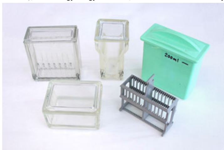
2.33. ábra. Álló és fekvő üveg, valamint tárgylemeztartó betéttel rendelkező műanyag küvetta
