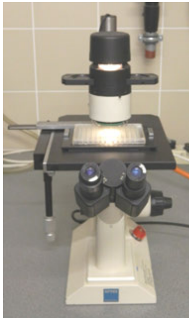
5.53. ábra. Fordított állású mikroszkóp oldalnézete. A tárgyasztalon tenyészfalaska látható, amelynek mozgatása a tárgyasztalon általában szabad kézzel történik
