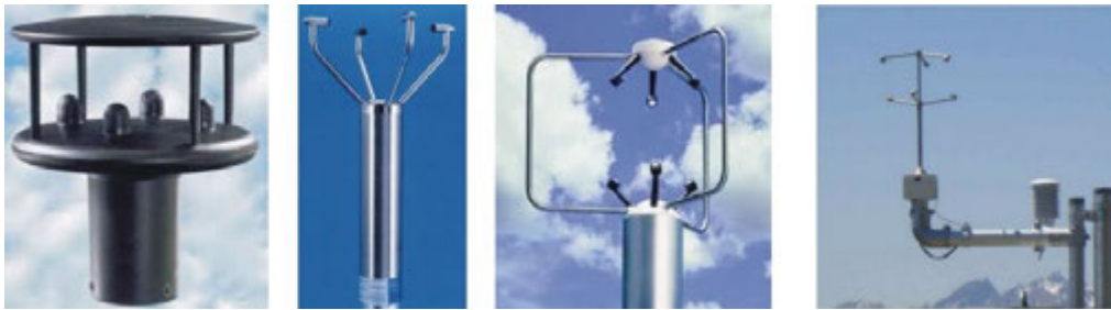
4.8. ábra. Ultrahangos áramlásmérők (anemométerek) különböző fajtái
