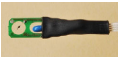
4.9. ábra: Hődrótos anemométer érzékelője.
