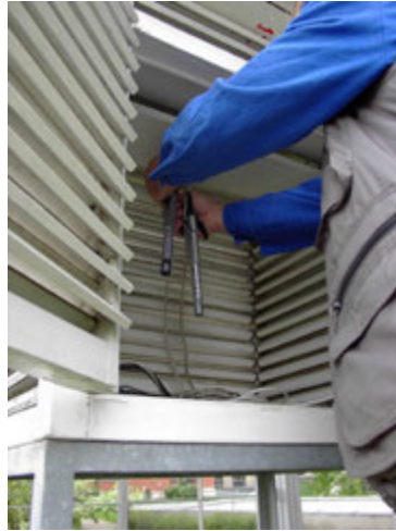
15.2. ábra: A hőmérő/relatív nedvesség-mérő szenzort cseréli az Országos Meteorológiai Szolgálat munkatársa az Eötvös Loránd Tudományegyetem meteorológiai állomásán. A leszerelt műszereket a nemzeti meteorológiai központban ellenőrzik és később egy másik állomáson helyezik el. A leszerelt eszközök helyére kalibrált, ellenőrzött műszerek kerülnek.
