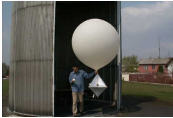
8.9. ábra: A ballonra erősítenek egy szögletvisszaverőt és a rádiószondát. (Országos Meteorológiai Szolgálat, Pestszentlőrinci Főobszervatórium). A ballont a hangárban fújják fel, majd kihozzák egy szabad területre, ahonnan a felbocsátás történik.
