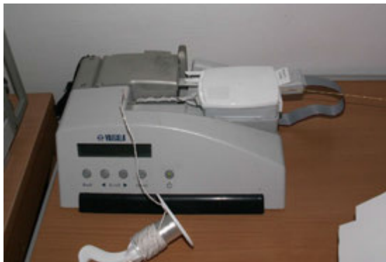
8.6. ábra: Rádiószonda kalibrálása felbocsátás előtt az Országos Meteorológiai Szolgálat Pestszentlőrinci Obszervatóriumában
