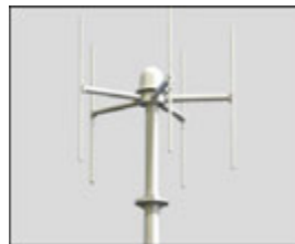
10.4. ábra: A SAFIR (System d’Alerte Foudre par Interferometrie Radioelectrique) rendszer villámdetektáló antennája (www.vaisala.com)
