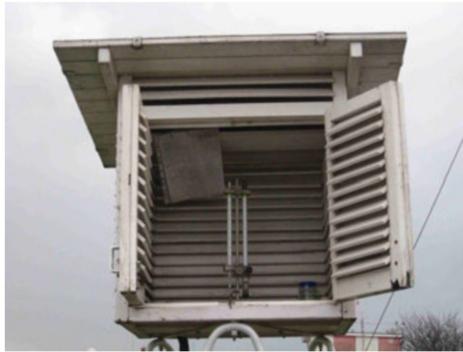
3.10. ábra: Stevenson-féle hőmérőház. A hőmérőket fehérre festett, dupla zsaluzású házikóban helyezik el a felszín felett 2m magasságban. Az árnyékolás a Nap közvetlen sugarainak hatását gátolja, a zsaluzott falak az erős szél hatását redukálják, a légmozgást azonban biztosítják.
