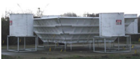
9.12. ábra: Az Országos Meteorológiai Szolgálat szegedi meteorológiai állomásán található Waisala Lap 3000 típusú RASS (Rádió-akusztikus szondázó rendszer)
