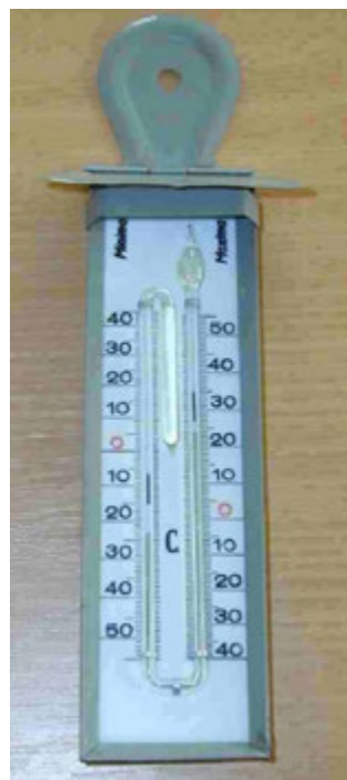
3.3. ábra: Six-rendszerű maximum-minimum hőmérő
