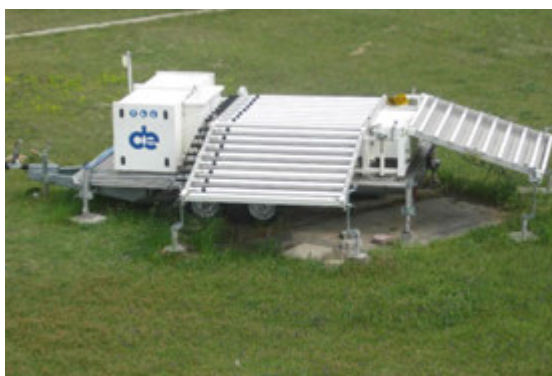
9.10. ábra: Az Országos Meteorológiai Szolgálat Budapest Pestszentlőrinci Főobszervatóriumában található Degenere Pcl 1300 típusú wind-profiler.
