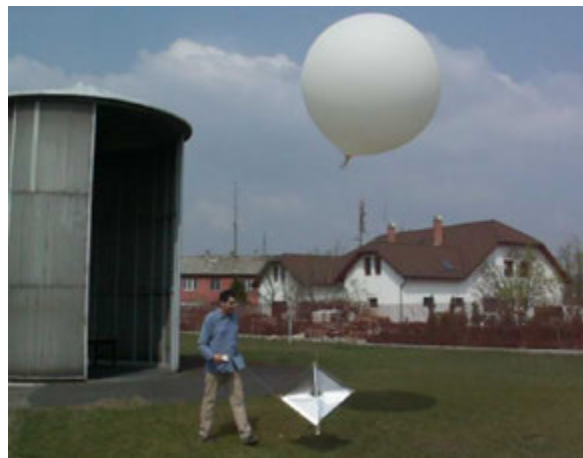
8.10. ábra: A rádiószonda felbocsátása (Országos Meteorológiai Szolgálat, Pestszentlőrinci Főobszervatórium). A magyarországi gyakorlatban a Vaisala RS92-SGP rádiószondákat alkalmazzák.
