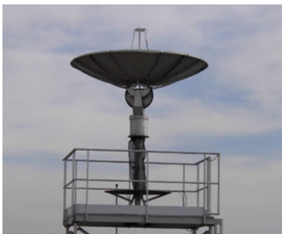
13.1. ábra: Az Eötvös Loránd Tudományegyetem Földrajz- és Földtudományi Intézetének HRPT (High Resolution Picture Transmission) vevőállomása az egyetem légymányosi épületének tetején
