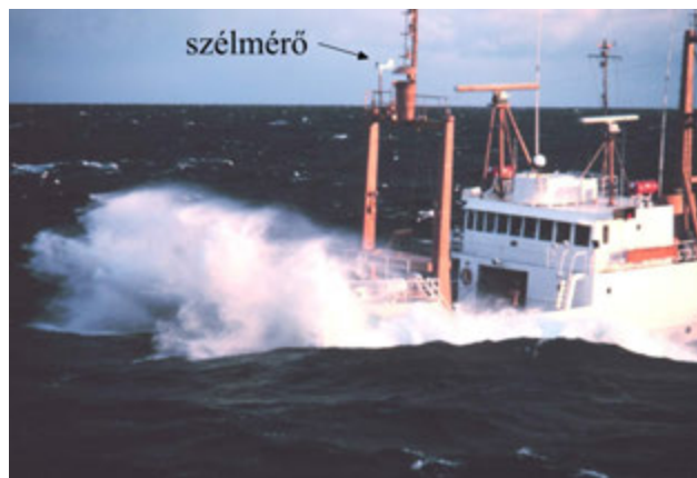
10.1. ábra: Propelleres szélmérő egy hajó elején. A mérést befolyásolhatja a hajótest áramlasmódosító hatása és az erős hullámmás. A tényleges szélvektort a hajó sebességvektorát figyelembe véve számítják.
