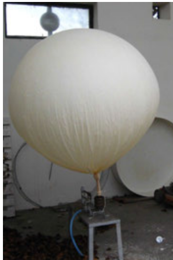
8.8. ábra: A ballonba töltött gáz mennyiségét egy mérleg szabályozza. Ha az előre beállított mennyiségű gáz a ballonba jutott, a gázcsap automatikusan elzár (Országos Meteorológiai Szolgálat, szegedi meteorológiai állomás).
