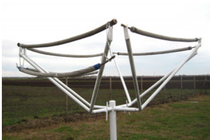
4.20. ábra: Hagyományos zúzmaramérő eszköz
