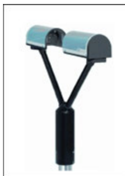
4.18. ábra: OTT Parsivel 2 típusú lézeres cseppspektrum-mérő (www.ott.com). Az Országos Meteorológia Szolgálat 14 állomáson tervezi az alkalmazásukat.
