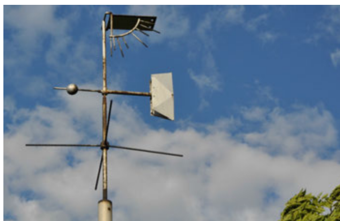
4.4. ábra: Nyomólapos szélmérő a Dobogókőn (700 m). A szélzászló segítségével mindig a szél irányába fordul. A szélmérő már csak tájékoztatást ad, a mérést nem ezzel a műszerrel végzik. A képen a szélmérő teljesen kilendül, ami legalább 20 m/s-os pillanatnyi szelet jelez.
