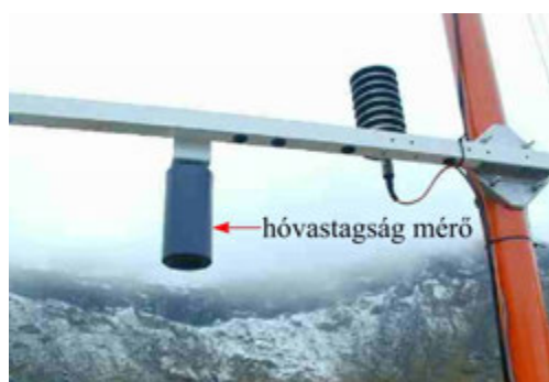
4.16. ábra: Hóvastagság-mérő szenzor a Fogarasi-havasokban (Bâlea lac állomás, 2034 m)
