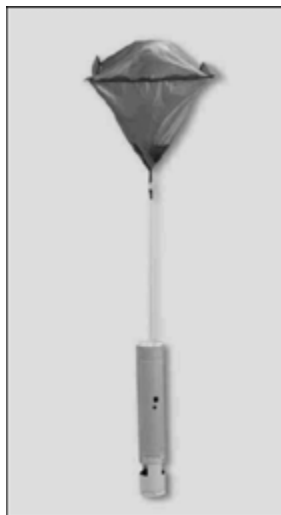
8.12. ábra: Vaisala RD94 típusú vetőszonda ( www.vaisala.com )
