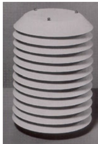
3.11. ábra: Elektromos hőmérő árnyékolására használt lapok. A lapok felső része fehérre festve, a lapok közötti rész a levegő áramlását biztosítja.
