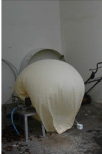
8.7. ábra: Rádiószonda mérésekhez használt ballon felfújása hidrogénnel megfelelő helyiségben (Országos Meteorológiai Szolgálat szegedi meteorológiai állomás).
