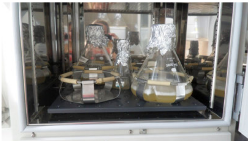
12.8. ábra: Rázató inkubátor prokarióta és eukarióta szuszpenziós kultúrához
