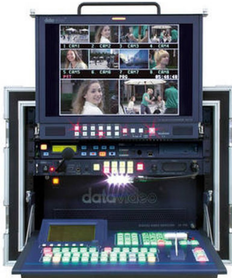
6.8 ábra Egy 8 kamera fogadására alkalmas mobil stúdió
