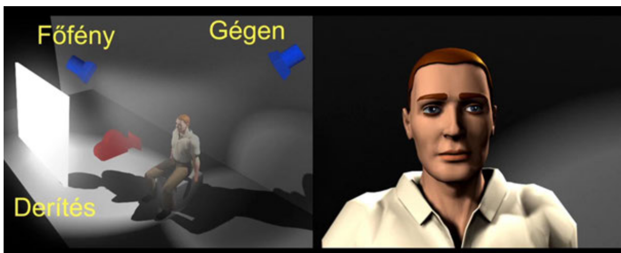
7.26 ábra A háromszög világítás sematikus ábrája - video
