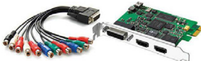
6.18 ábra Egy korszerű editáló kártya és csatlakozói.
