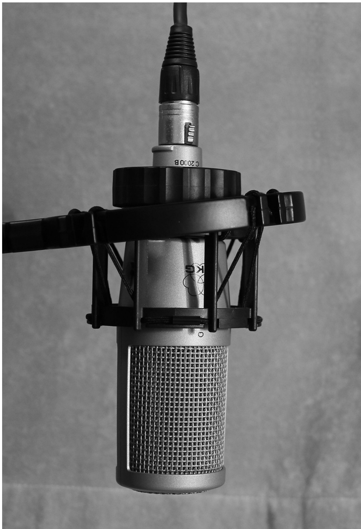
2.4 ábra Kondenzátor mikrofon rugalmas felfüggesztéssel
