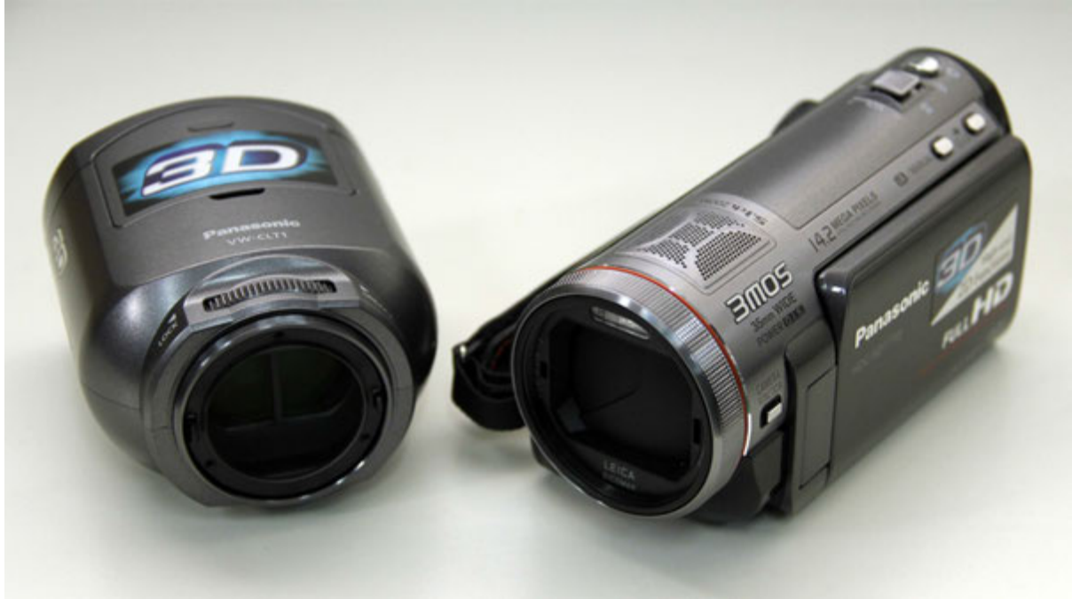
5.17 ábra HD kamera a 3D-t létrehozó ikeroptikai előtéttel
