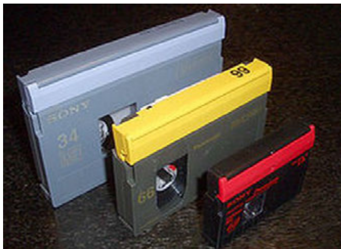
5.10 ábra A DVCAM, a DVC PRO és a mini DV kazetta 11
