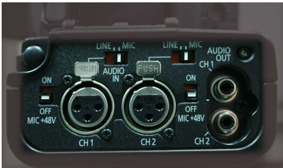
9.5 ábra A hangcsatlakozó panel
