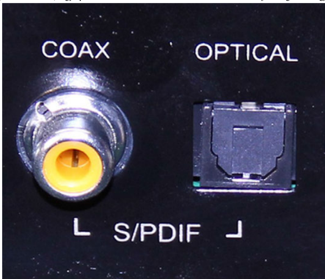
2.19-es ábra S/PDIF csatlakozás RCA és Toslink aljzattal
