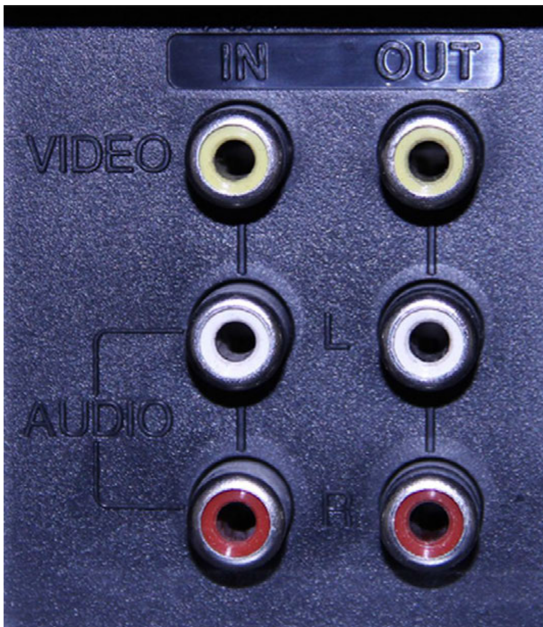
2.6 ábra Videomagnó ki-és bemeneti csatlakozói
