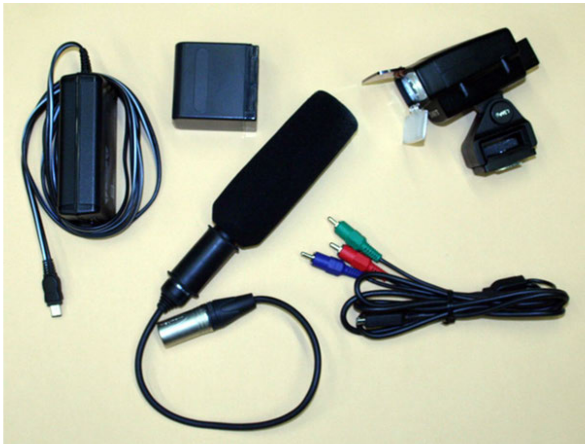
6.6 ábra Kamerához tartozó kiegészítők, hálózati adapter, akkumulátor, kispuska mikrofon, fejlámpa, kimeneti kábel látható.
