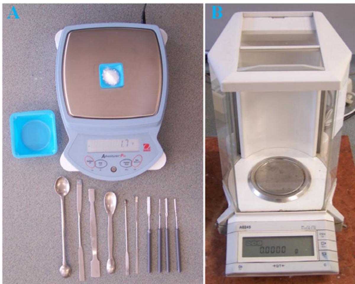
1.11. ábra. A: Digitális mérleg kimérő edénykével, spatulákkal és vegyszereskanalakkal; B: Analitikai mérleg rezgésmentes asztalon.
