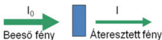
4.1. ábra. A beeső és az áteresztett fény. A minta által elnyelt fényt a beeső és az áteresztett fényintenzitás hányadosával jellemezzük.
