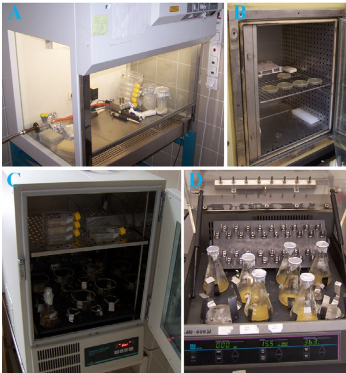
1.14. ábra. A: Steril fülke; B: Inkubátor (37 °C), benne baktérium tenyészetek agarlemezekon; C: Inkubátor (37 °C), benne eukarióta sejttenyészetek; D: Fűthető rázó inkubátor (37 °C), benne folyadékkultúrában növekvő E. coli baktériumok.
