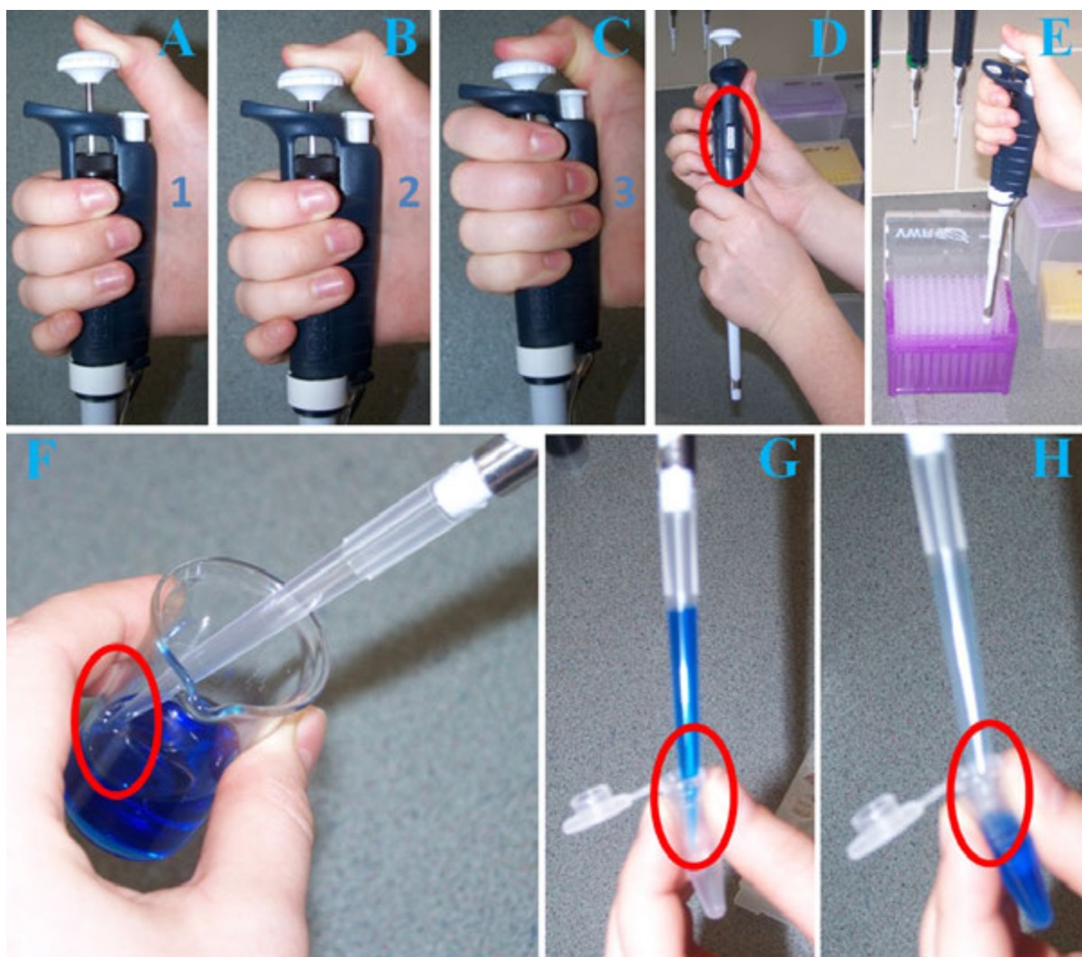
1.9. ábra. A-B: A pipetta dugattyújának három állása; D-H: A pipettázás folyamata (D: térfogat beállítása, E: pipettahegy rögzítése, F: a folyadék felszívása, G: a hegy áthelyezése egy új csőbe, H: a folyadék leeresztése).
