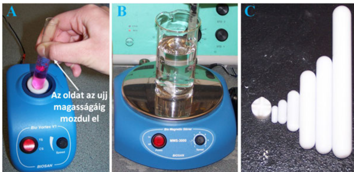
1.10. ábra. A: Folyadék keverése Vortex keverővel; B: Folyadék keverése pH mérés közben, mágneses keverő segítségével (a folyadékba fentről belemerül a pH mérő berendezés kombinált üvegelektrodja); C: Különböző méretű és alakú, teflonnal bevont, mágneses keverőbabák.
