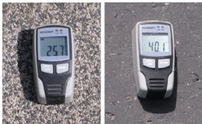
12.10. ábra: Az eltérő útburkolatok hatására a felszínhőmérsékletek jelentősen eltérnek.
