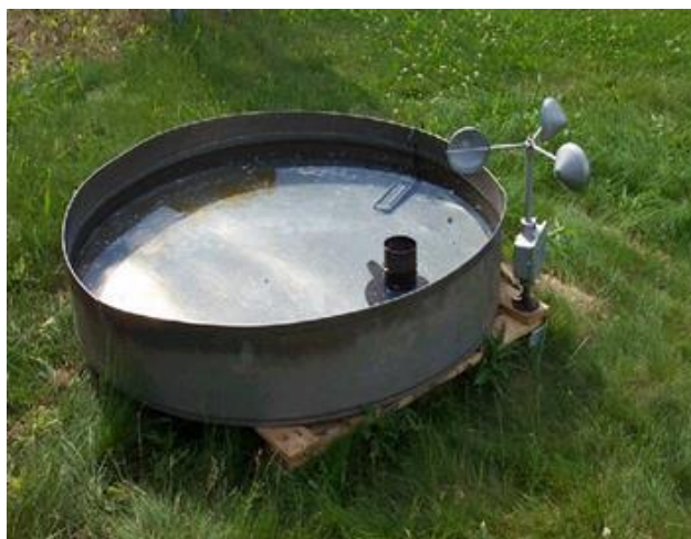
3.14. ábra. A Magyarországon használt „A” típusú párolgásmérő kád
