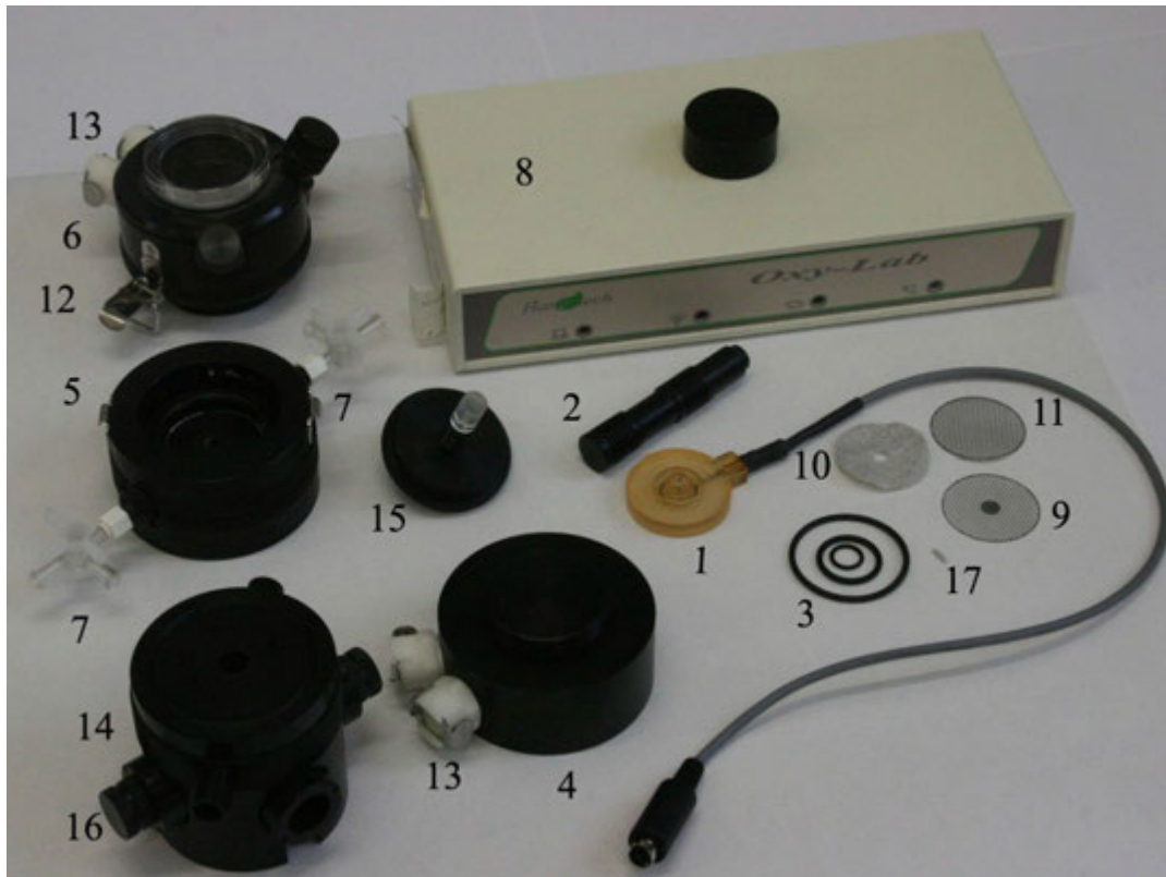
6.1. ábra. A Hansatech-típusú O 2 -elektród részei. A számozott részek leírását lásd a szövegben.
