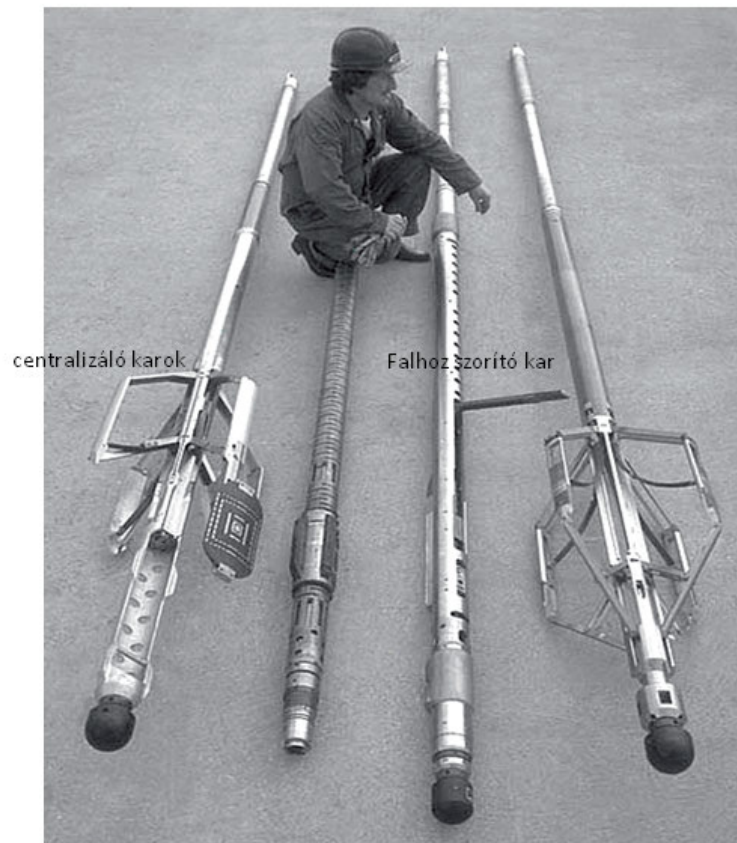
3.2. ábra. Geofizikai szondák. (centralizált és falhoz szorított eszközök)
