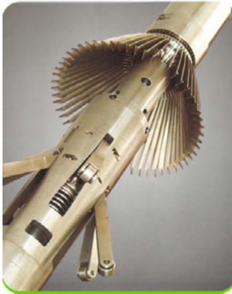
15.5. ábra. Sokkaros lyukbőrségmérő
