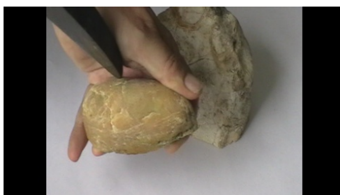
III.8. videó: A képre kattintva egy videofelvételen mutatjuk be a kőzetek karcpróbáját kalapáccsal.
