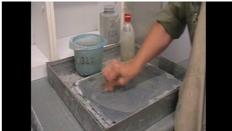
III.25. videó: A csiszolást egyre finomabb porokon folytatjuk. A képre kattintva a '300'-as poron való csiszolást mutatjuk meg videofelvételen.
