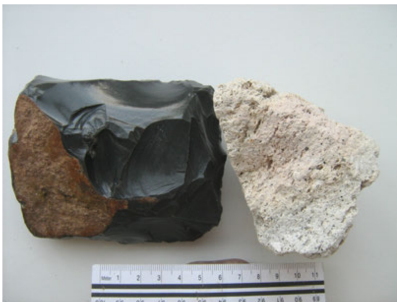
III.9. ábra – Hasonló kémiai összetételű, de más szerkezetű kőzetek: obszidián (bal) és horzsakő (jobb)
