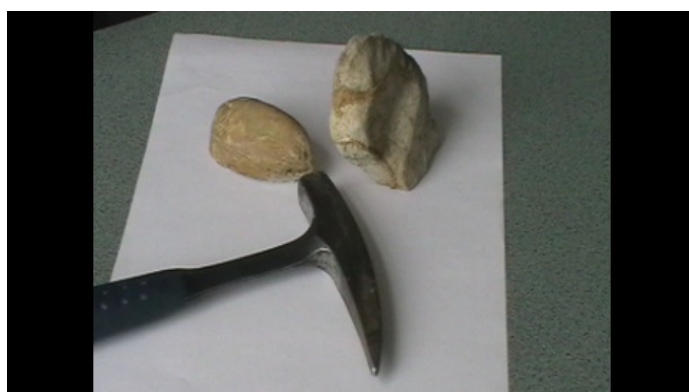
III.9. videó: A képre kattintva egy videofelvételen mutatjuk be, hogy keménységpróbát lehet végezni úgy is, hogy geológus kalapácsunkat kíséreljük a kőzettel megkarcolni.
