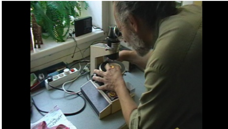
III.37. videó: Rövid csiszolás után mikroszkópban ellenőrizzük a vékonycsiszolat vastagságát. Ezt többször is megismételhetjük. A képre kattintva erről tekinthető meg videofelvétel.
