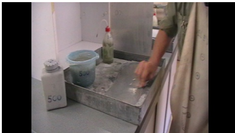
III.26. videó: A csiszolást az '500'-as poron folytatjuk. A képre kattintva erről tekinthető meg videofelvétel.
