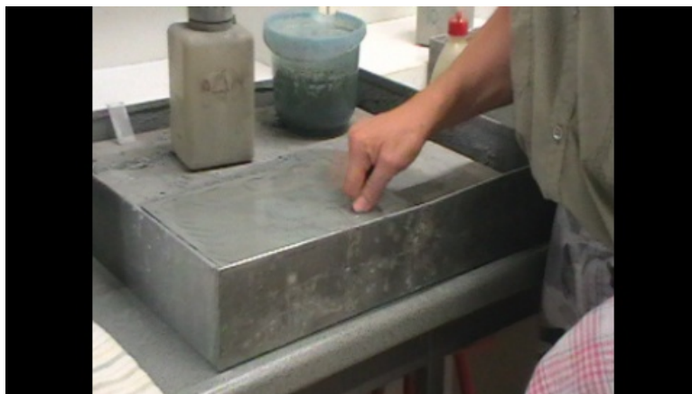
III.38. videó: Folytatjuk a csiszolást a '800'-as poron. A képre kattintva erről tekinthető meg videofelvétel.
