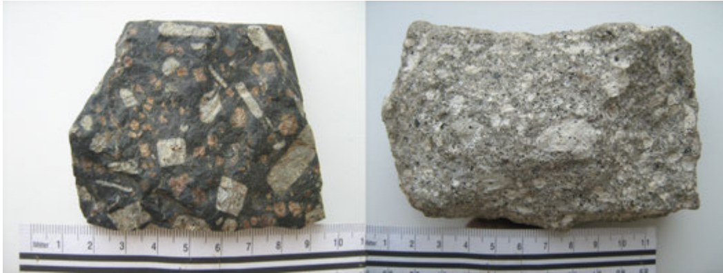
III.11. ábra – Porfirok szövetű lávakőzet (bal) és lapillitufa (jobb)
