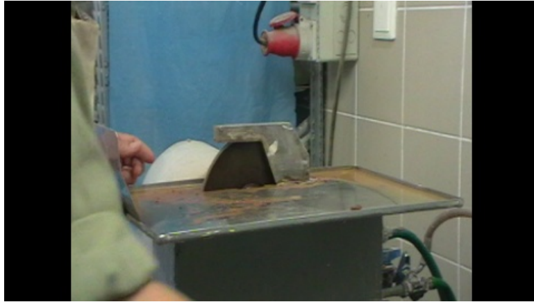
III.21. videó: Vágás után nagyon fontos a vágógép tisztítása. Ezt a képre kattintva egy videofelvételen mutatjuk be.
