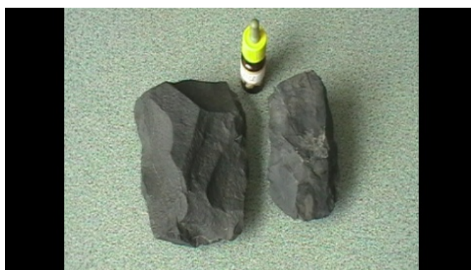
III.14. videó: A képre kattintva egy videofelvételen mutatjuk be, hogyan tudunk különbséget tenni bazalt és bitumenes mészkő között sósav használatával.
