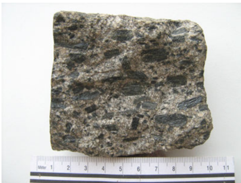
III.13. ábra – Irányított szövetű magmás kőzet (andezit). Az irányítottság legjobban az amfibolokon figyelhető meg.
