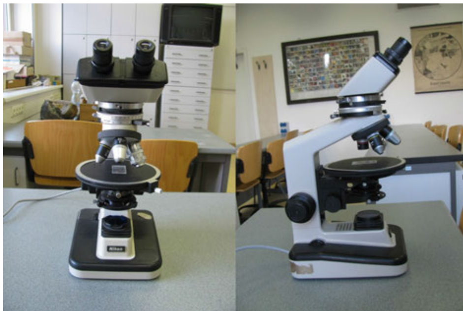
III.40. ábra – Polarizációs kőzettani mikroszkóp és annak részei (fenti kép). Az ELTE Kőzettan-Geokémiai tanszék hallgatói mikroszkópként használt Nikon polarizációs mikroszkóp két nézete (alsó két kép)
