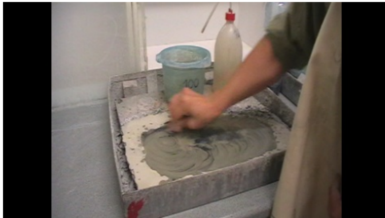
III.24. videó: A levágott minta egyik felét nagyon simára kell csiszolni, ezt a legdurvább csiszolóporon kezdjük (SiC csiszolóport használunk, melynek szemcsemérete annál kisebb, minél nagyobb számmal jelölik a port). A képre kattintva egy videofelvételen mutatjuk be a csiszolást a legdurvább, '100'-as poron.
