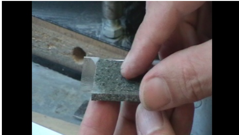
III.33. videó: Ezt követően felragaszthatjuk a mintát a tárgylemezre. A képre kattintva erről tekinthető meg videofelvétel.
