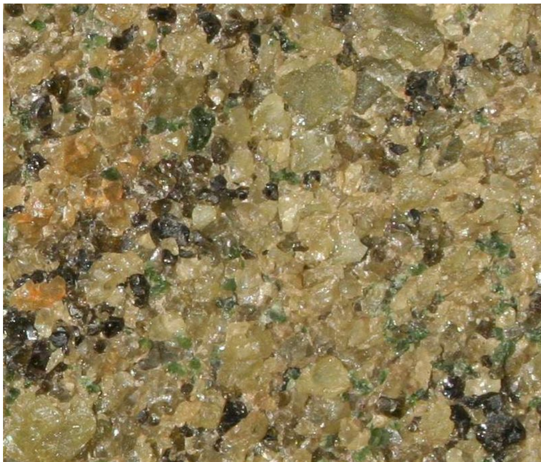
III.31. ábra – Peridotit xenolit közeli képe: az uralkodó mennyiségű halványzöld olivin kristályok mellett, sötét színű ortopiroxének és fűzöld klinopiroxének ismerhetők fel.
