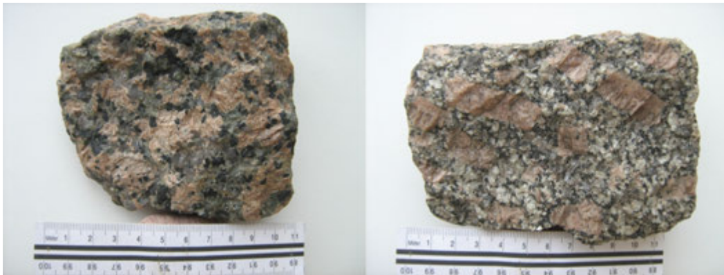
III.10. ábra – Durvaszemcsés mélységi magmás kőzetek. Mind a két kőzet gránit, de a baloldali ekvigranuláris, a jobb oldali inekvigranuláris
