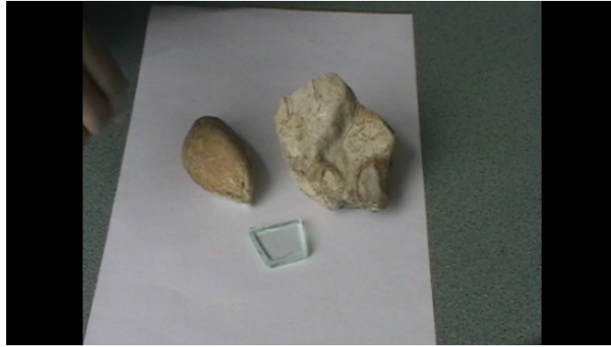
III.10. videó: A képre kattintva egy videofelvételen mutatjuk be a kőzetek karcpróbáját üveglapon.
