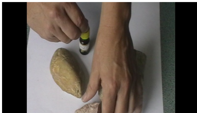
III.13. videó: A képre kattintva egy videofelvételen mutatjuk be, hogy gyenge sósavban a dolomit nem oldódik, de a pora igen.
