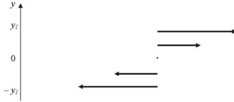
XII.2.4. ábra. A szélirány megváltozásával járó horizontális szélnyírás modellje.
