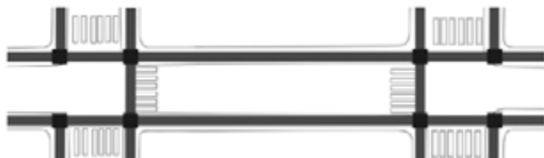
3. ábra - Levezetett gyalogos gráf az előző példa útszakaszára. Az átkelők nélkül szigetek keletkeznek.
